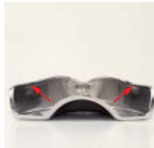
Bild eines geschlossenen Randes bei einem Metall-Löffel
